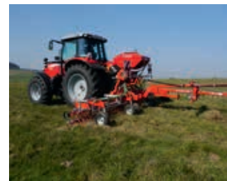
Pneumatisch zaaiapparaat Verdeelt het zaaizaad nauwkeurig volvelds.
